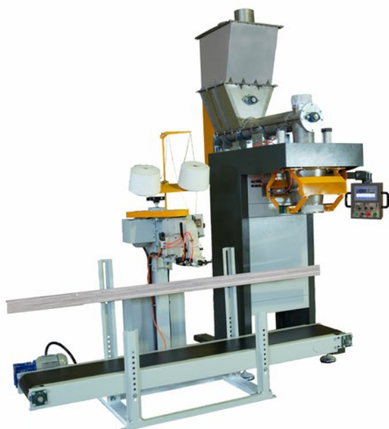
کیسه پرکن پودری گراس ویت تک توزین (توزین در کیسه)
